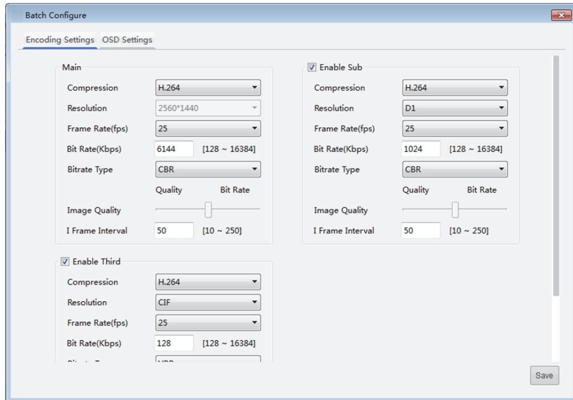
2. Cliquez sur l'onglet **Encoding**, puis modifiez les paramètres nécessaires. Pour les descriptions des principaux paramètres, consultez [Configuration des paramètres d'encodage pour une seule caméra IP](#).
