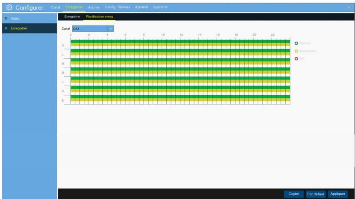
La programmation des enregistrements vous laisse programmer en fonction des jours et des heures en enregistrement normal, enregistrement par détection de mouvement ou/et enregistrement alarme.
