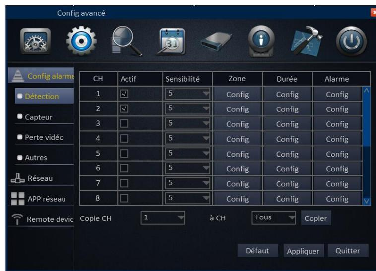
Ici, nous choisissons d'activer la détection de Mouvement pour les caméras 1 et 2.
