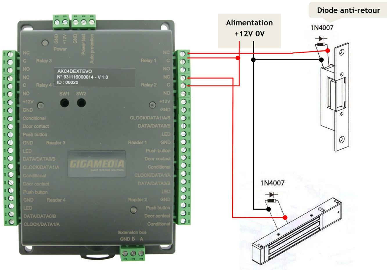
**ATTENTION :** Afin d'éviter tous dysfonctionnements aléatoires qui viendraient perturber la bonne utilisation du système due à des courants de retour, il est impératif d'utiliser et de raccorder les diodes anti-retour livrées avec la centrale suivant le schéma de câblage ci-dessus.
