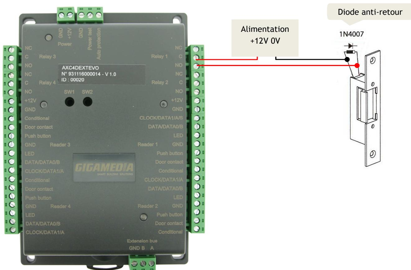
**ATTENTION :** Afin d'éviter tous dysfonctionnements aléatoires qui viendraient perturber la bonne utilisation du système due à des courants de retour, il est impératif d'utiliser et de raccorder les diodes anti-retour livrées avec la centrale suivant le schéma de câblage ci-dessus.
