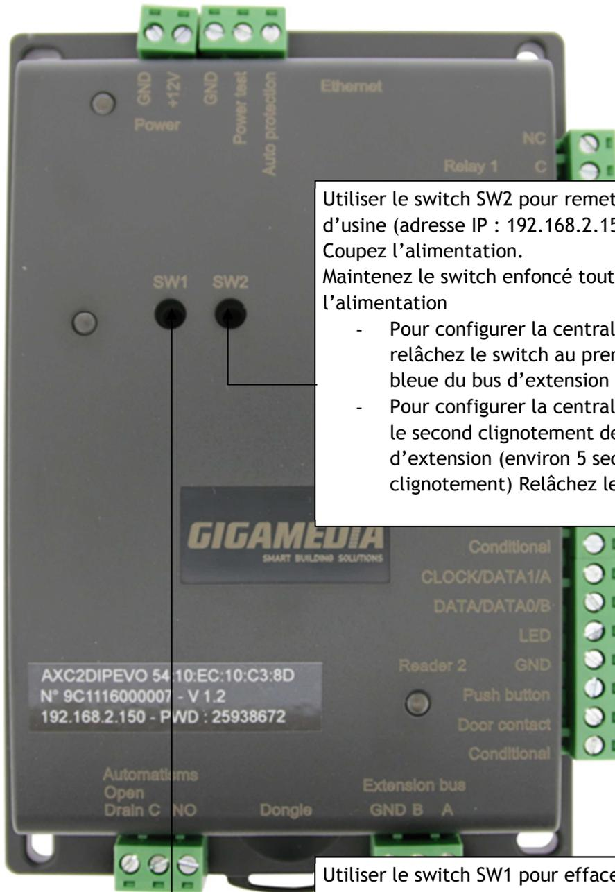
Utiliser le switch SW2 pour remettre les paramètres réseau d'usine (adresse IP : 192.168.2.150, masque 255.255.255.0). Coupez l'alimentation. Maintenez le switch enfoncé tout en remettant l'alimentation
